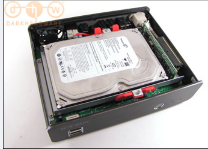
Sabit diskin ba•lanaca•ı tepsi ve disk, cihaza monte edilmi• halde
